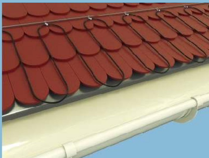
Przykład ogrzewania krawędzi dachu
