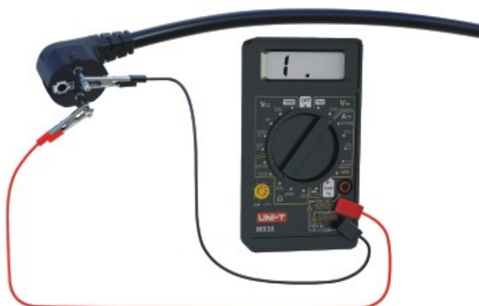
Pomiar rezystancji żyły grzejnej
